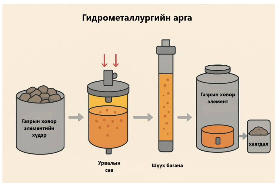
Зураг 25. "REMAFs" буюу гидрометаллургийн боловсруулалтын технологийн зураг
